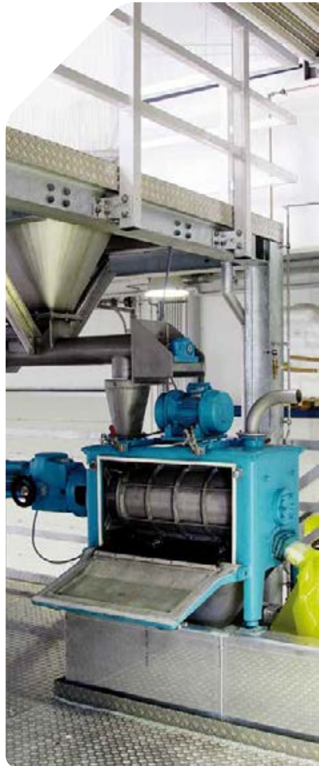
Vibrationsiebmaschine mit Siebhalbschale mit Vibrations- oder Ultraschallüberlagerung
