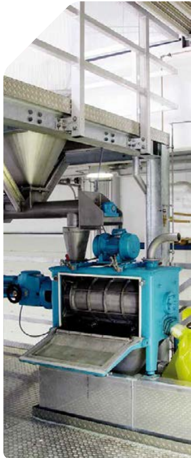
Vibrationsiebmaschine mit Siebhalbschale mit Vibrations- oder Ultraschallüberlagerung
