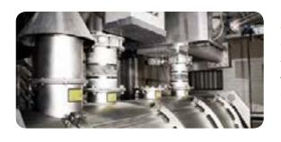
3,0 m -Pflugscharmischanlage mit Schneckendosierung; Abluftfilterung mit großer Reinigungsklappe
